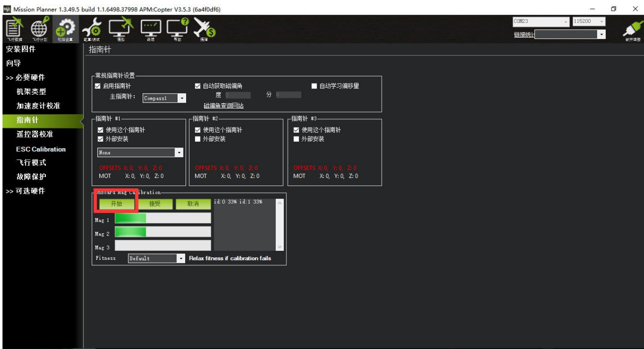
此图中为 GPS 和飞控方向一致 当安装方向选择并固定好后，点击 开始 按钮，转动飞控与 GPS
