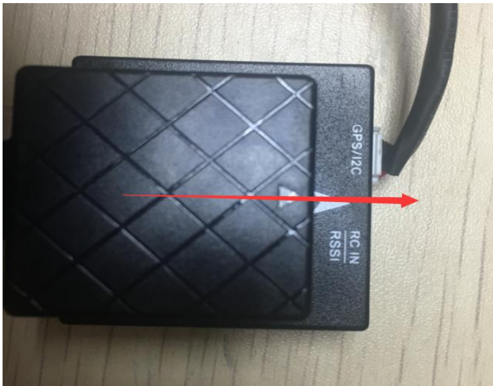
此图中为 GPS 和飞控方向一致 当安装方向选择并固定好后，点击 开始 按钮，转动飞控与 GPS
