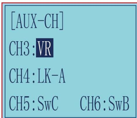
Die Servoposition für den 3. Kanal und den 4. Kanal kann vom Sender aus eingestellt werden. Wenn der 3. Kanal der Taste des 3. Kanals zugewiesen ist, ist diese Einstellung mit der Taste verknüpft. Sie können auch 3. Kanal, 4. Kanal, 5. Kanal und 6. Kanal gleichzeitig als VR oder SW einstellen.
