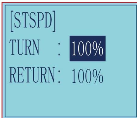
Diese Funktion wird verwendet, um die Verzögerung des Lenkservos (1. Kanal) einzustellen, damit sich das Servo langsam dreht. Ein schneller Lenkvorgang führt zu einem kurzzeitigen Untersteuern, Geschwindigkeitsverlust oder Schleudern. Diese Funktion ist in solchen Fällen wirksam.
