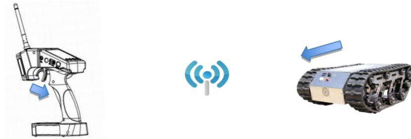
もし、動きが上記と逆になる場合、下記の図のように、スロットルチャンネルのリバースの設定を行ってください。詳しい手順について、「2.13. サーボリバース機能(REV)」に参考してください。
