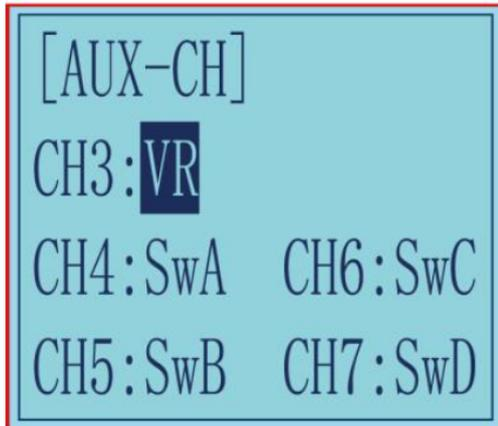
補助チャンネルの制御スイッチは、ST、TH、VR、SwA、SwB、SwC、SwD、LK-A、LK-B、LK-C、LK-D、NULLとして選択できます。NULLに設定されている場合、チャンネルはどのスイッチによっても制御されません。
