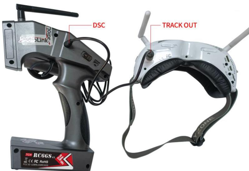
ヘッドトラッキングモードを指定する場合、RC6GS V3のデフォルト設定として、CH5とCH6はジンバルのサーボ用の出力ポートになります。
