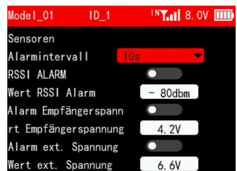
RSSI-Alarmwert: Wenn der RSSI-Signalstärkewert des Empfängers größer als der eingestellte RSSI-Alarmwert ist, sendet die Fernsteuerung eine Alarmerinnerung, der Höchstwert kann auf -100dbm eingestellt werden, die Standardwert ist -80dbm, der spezifische eingestellte Wert kann durch die Fernsteuerung und den Empfänger-Feldabstandstest ermittelt werden.
