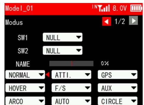
Bewegen Sie den Cursor auf den Namen des Flugmodells, drücken Sie kurz den Pushknopf und drehen Sie dann den Pushknopf, um den Flugmodus auszuwählen. Wenn der Modus-Knopf eingestellt ist, können Sie den Schalter umschalten, das kleine rote Dreieck hinter dem Flugmodus entspricht dem Flugmodus in der aktuellen Position des Schalters.
