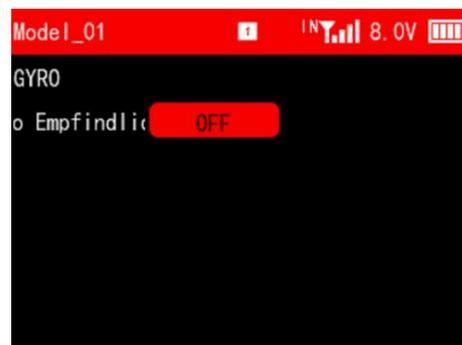
**Hinweis:** Die Funktion zur Einstellung der Gyro-Empfindlichkeit ist nur für Empfänger mit FHSS-V2-Protokoll verfügbar, einschließlich R8FGH, R8FG V2.1-Version, R4FGM V2.1-Version und R8FG- und R4FGM-Empfänger mit dem **Werkdatum 2023/4/26 und später**; andere Empfänger können 8 Kanäle zur Einstellung der Empfindlichkeit verwenden, und stellen Sie einfach einen Knopfschalter für die 8 Kanäle ein.
