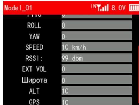
Wenn T12D mit dem R16F-Empfänger, der Flugsteuerung und dem GPS verwendet wird, verbinden Sie die Mavlink-Anschluss des R16F mit der TELEM-Anschluss der Flugsteuerung (wie untenes Bild), und stellen Sie dann die Parameter der Flugsteuerung in der Bodenstation ein, dann können Sie die Informationen der Flugsteuerung an die Schnittstelle der Flugsteuerungstelemetrie der T12D-Fernsteuerung zurücksenden.
