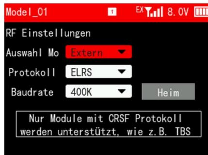
Protokoll: ELRS und CRSF V2 sind optional. Bei Verwendung unterschiedlicher Module werden unterschiedliche Protokolle ausgewählt.
