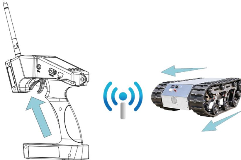
Einstellung von „Lenkung in Gas“ abgeschlossen, beide Ketten bewegen sich nach vorne, wenn der Gashebel gezogen wird
