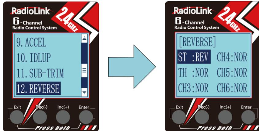
Wenn die Rückwärtslenkung korrekt ist, überspringen Sie diese Einrichtung der Rückwärtslenkung. Nach dem Einstellen des Gas-/Lenkung-Servoreverses kann die Mischungssteuerung eingestellt werden.
