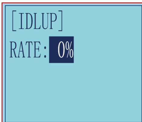
Verwenden Sie diese Funktion, um die Starteigenschaften des Motors zu verbessern, indem Sie die Leerlaufdrehzahl beim Starten des Motors eines gasbetriebenen Autos erhöhen.
