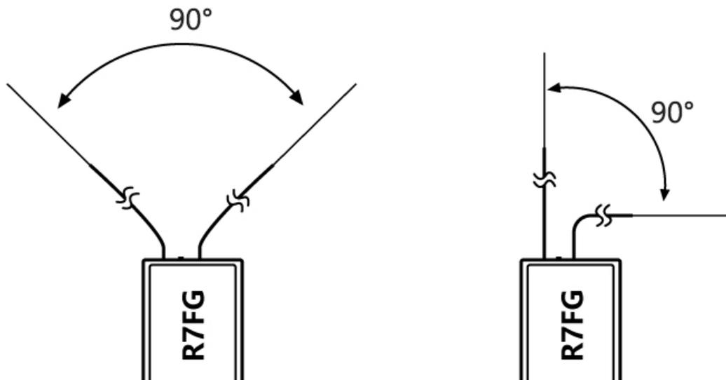
3. Große Modelle können Metallteile haben, die die Signalübertragung beeinträchtigen, in diesem Fall sollten sich die Antennen auf beiden Seiten des Modells befinden. Auf diese Weise kann in jedem Arbeitszustand der beste Signalzustand aufrechterhalten werden.
