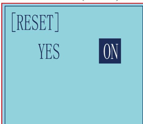
Alle Daten aller in der Fernsteuerung gespeicherten Modelle können auf die Werkseinstellung zurückgesetzt werden. Diese Funktion wird häufig verwendet, um neue Modelldaten einzustellen oder zuvor gespeicherte Daten zu löschen.
