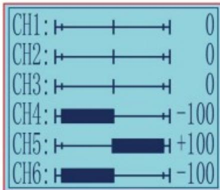
Drücken Sie nach dem Einschalten die „Exit“-Taste in der Hauptanzeige, um die Endpunktanpassungen jedes Kanals aufzurufen.
