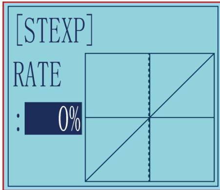
beide Endpositionen herum zu ändern. Sie hat keinen Einfluss auf den maximalen Servoweg. Stellen Sie die Empfindlichkeit des Richtungsrad sowohl in der neutralen Position als auch am Ende ein.
