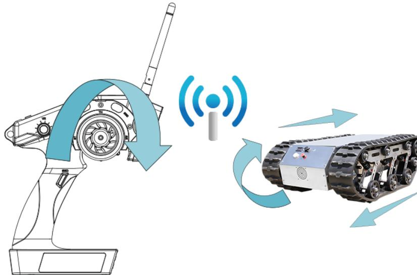
Die Einrichtung von „Gas in Lenkung“ ist abgeschlossen, die linke Kette bewegt sich vorwärts und die rechte rückwärts, wenn das Rad im Uhrzeigersinn gedreht wird. Das Differential realisiert das Rechtsdrehen des Kettenfahrzeugs
