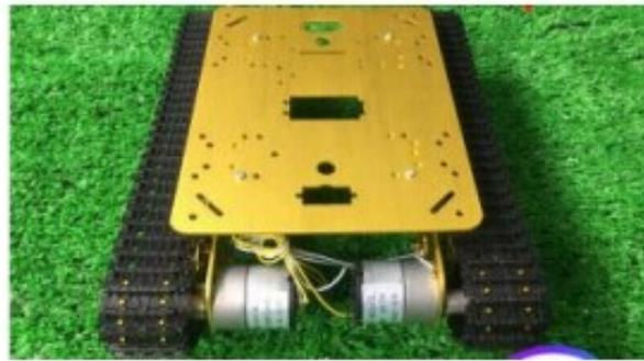
Mischsteuerung: Der Gashebel (eine Funktion) an der R/C überwacht zwei Motoren (zwei ausführende Einheiten), die sich gleichzeitig vorwärts/rückwärts bewegen. Das heißt, ONE TO TWO Mix-Steuerung. Andererseits macht das Drehen des Lenkrads einen Motor vorwärts und den anderen gleichzeitig rückwärts, um eine Richtungsrotation zu erreichen. Identisch mit der ONE TO TWO Mix-Steuerung.
