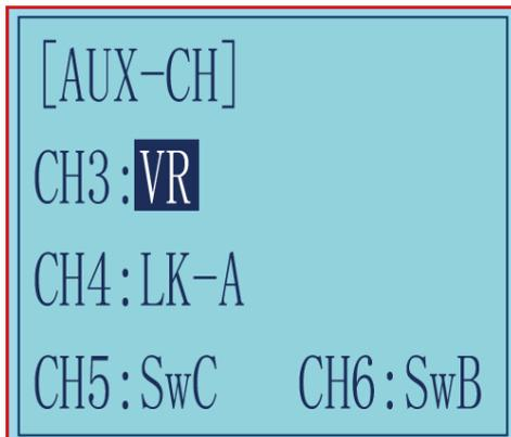
Die Servoposition für den 3. Kanal und den 4. Kanal kann vom Sender aus eingestellt werden. Wenn 3. Kanal der Taste des 3. Kanals zugewiesen ist, ist diese Einstellung mit der Taste verknüpft. Sie können auch 3. Kanal, 4. Kanal, 5. Kanal und 6. Kanal gleichzeitig als VR oder SW einstellen.
