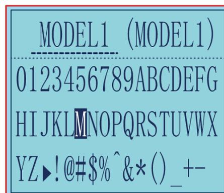
2. Drücken Sie die „Enter“-Taste, um in die NAME zu gelangen, das erste Zeichen des aktuellen Namens blinkt und das blinkende Zeichen kann zurückgesetzt werden. Die gebräuchlichen Zeichen erscheinen am unteren Rand des Bildschirms, verwenden Sie die Taste „Dec(-)“ oder „Inc(+)", um das gewünschte Zeichen auszuwählen. Drücken Sie erneut die „Enter“-Taste, das nächste Zeichen des aktuellen Namens blinkt. Setzen Sie andere Zeichen des aktuellen Namens auf die gleiche Weise zurück.
