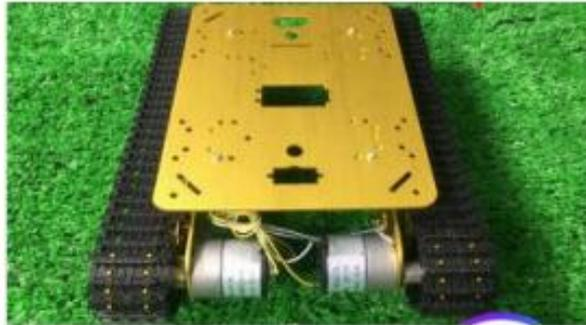
Mischsteuerung: Der Gashebel (eine Funktion) an der R/C überwacht zwei Motoren (zwei ausführende Einheiten), die sich gleichzeitig vorwärts/rückwärts bewegen. Das heißt, eins zu zwei Mix-Steuerung. Andererseits macht das Drehen des Lenkrads einen Motor vorwärts und den anderen gleichzeitig rückwärts, um eine Richtungsänderung zu erreichen. Identisch mit der eins zu zwei Mix-Steuerung.
