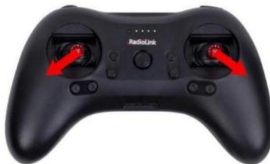
※RadioLink 以外、他者のプロポセットをご使用する場合も同様に、左スティック⇒左下、右スティック⇒右下を押します。校正が失敗する場合は、送信機のチャンネルの方向を変更してみてください。上記のようにジョイスティックを押すとき、チャンネル 1 からチャンネル 4 までの値の範囲が以下であることを確認してください。
