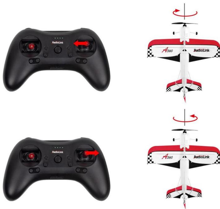
機体が垂直の状態、エレベーターのジョイスティック (CH2) を切り替えて、前進/後進を制御します。
