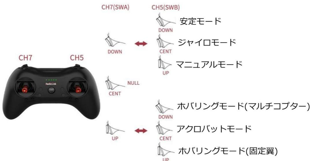
※T8FB 送信機使用時、初期設定では CH5(3 ウェイスイッチ)と CH7(2 ウェイスイッチ)でフライトモードの切替え制御を行います。
