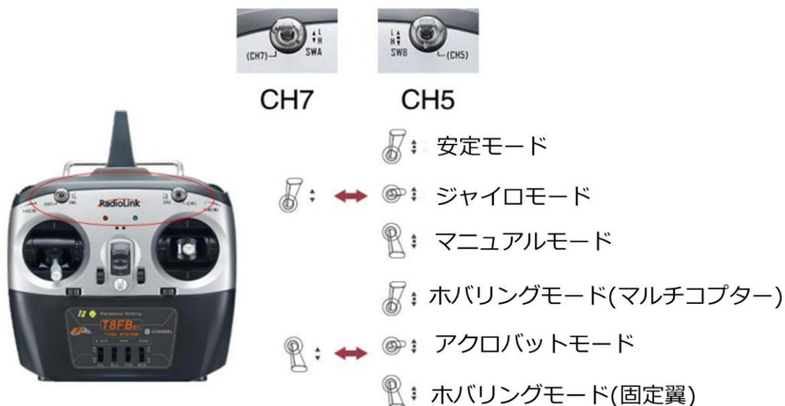
上記以外、他者のプロポをご利用する場合、下図をご参照して、フライトモードの切替える設定をしてください。フライトモードに対応するチャンネル 5(CH5)とチャンネル 7(CH7)の値の範囲は以下となります。
