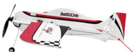
ラダージョイスティックを左に切り替えるとラダーサーボ（垂直尾翼）が左に回し、ジョイスティックを右に切り替えるとラダーサーボ（垂直尾翼）が右に回します。
