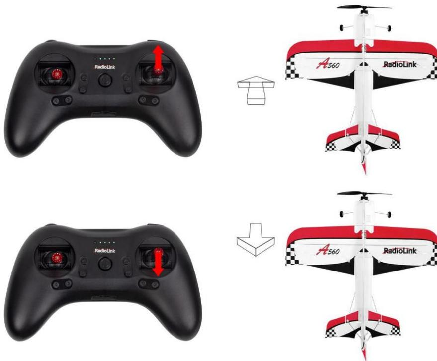
機体が垂直の状態、ラダージョイスティック (CH4) を切り替えて、機体の回転制御をします。
