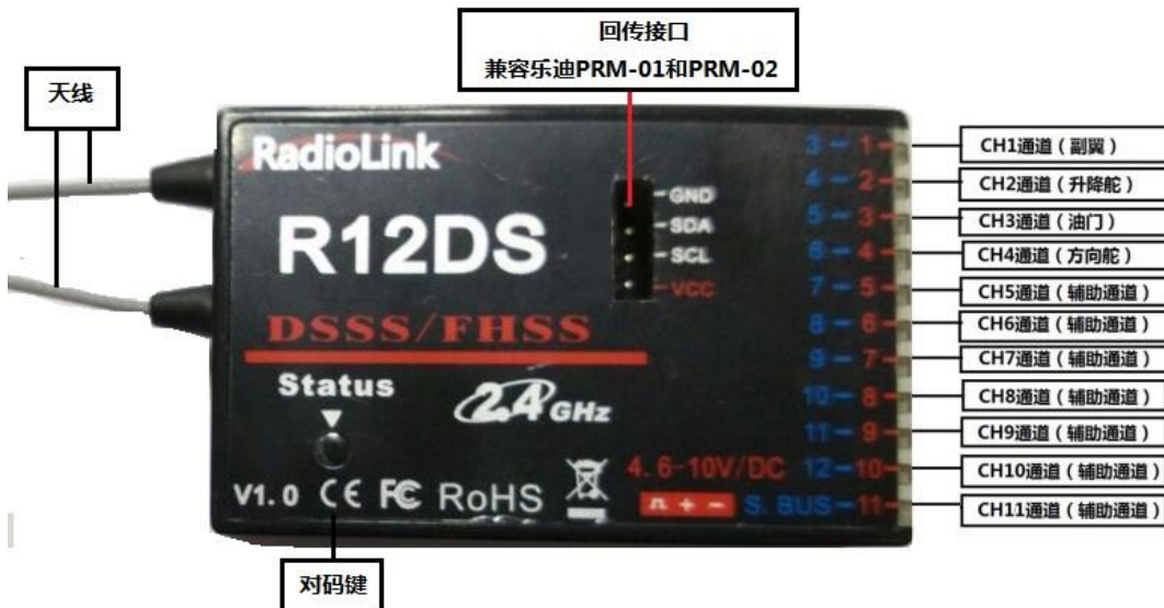
PWM信号模式, 红灯, 输出11个通道PWM信号
