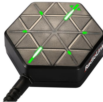
SE100 搜到星后靠近天线端指 示灯常亮，其他指示灯闪烁
