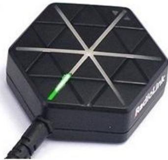
SE100 上电后靠近 天线端指示灯常亮
